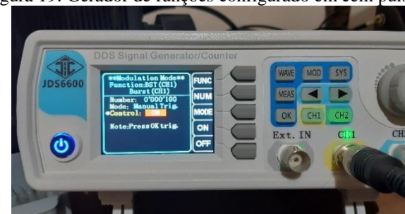
Figura 19: Gerador de funções configurado em cem pulsos.
